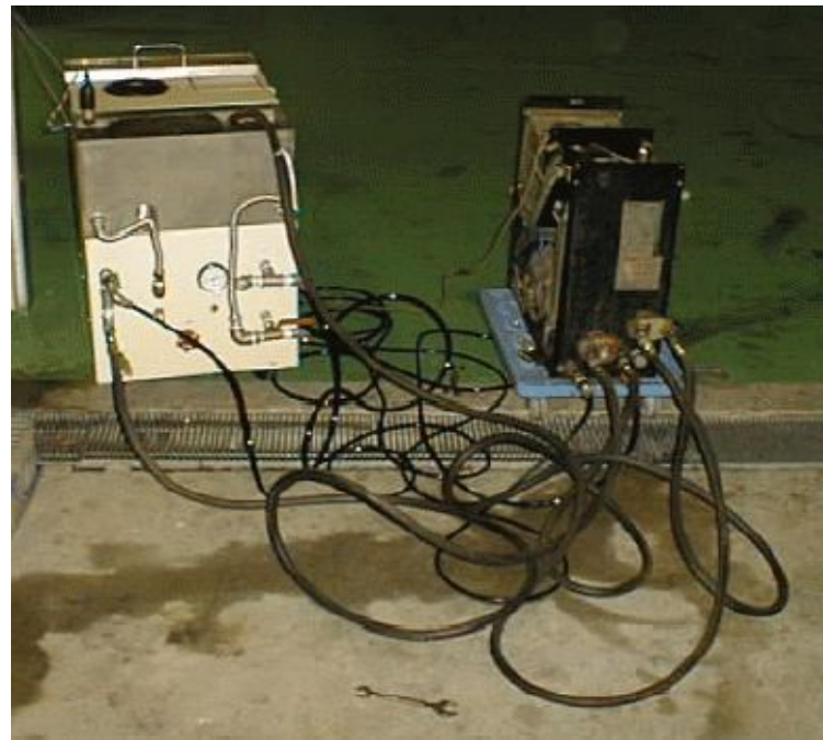
金型温度調節機洗浄中 洗浄対象M社製金型温度調節機
